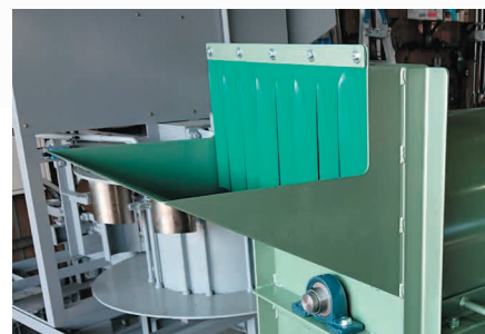
飛び散り防止カーテン
