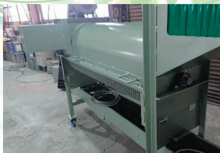
排出口左側(機内の回転翼逆転仕様)
