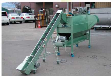
投入口仕様変更(投入用コンベアと接続)
