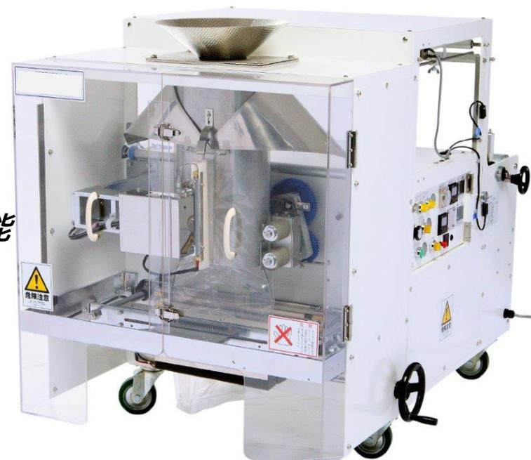
ロール状の包装材料を筒状に形成しながら製袋する途中で、計量器及び計数機などと連動で自動投入し、(手投入もOK)
